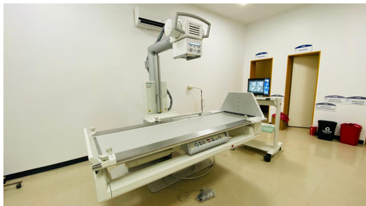
Imagen 2: Sistema telecomandado de radiografía y fluoroscopia
